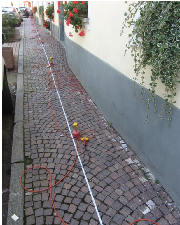
Fig. 8 - 9 Prova penetrometrica SCPT (S2) e stendimento geofonico per indagine sismica attiva (MASW).
