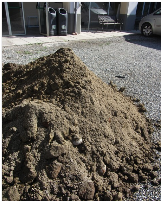
Fig. 6 - 7 Substrato naturale sabbioso alla base del livello di riporto e rimaneggiato, e materiale estratto
